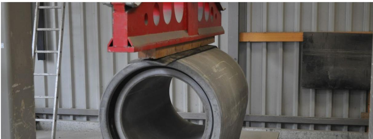
**Bild 1:** MAROWA® Hochleistungsbetonrohr werden statistisch nach Norm SN EN 1917 (SIA 190.171) überwacht und überprüft
