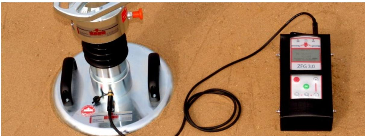
Bild 56: Kontrolle der Verdichtungsarbeiten mit dynamischen Lastplattenversuch
