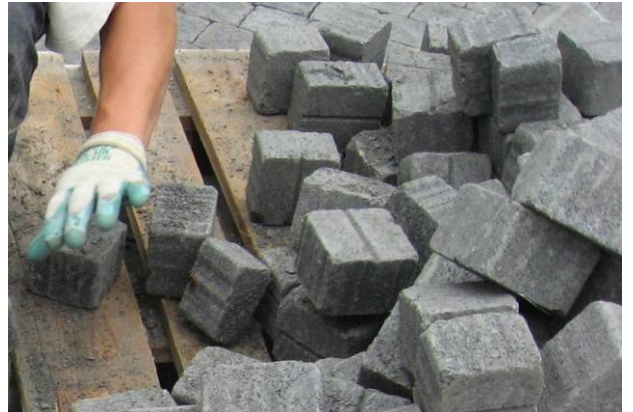
Bild 29: FRIEDA® Pflastersteine weisen auf der Unterseite eine Markierungs-Nut auf
