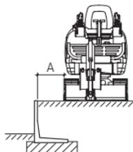
Der minimale Abstand  $A$  von der Mauerkrone beträgt für Kleinbagger (Gewicht  $\leq 3.5 \text{ to}$ ) 0.80 m. Für schwerere Bagger ist der Abstand entsprechend zu vergrößern.
