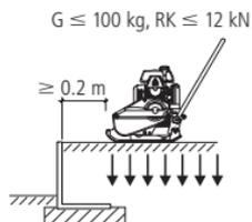
Je nach Lastfall und Hinterfüllung kann der angegebene Abstand, nach Rücksprache mit CREABETON BAUSTOFF AG, reduziert werden. Der minimale Abstand zwischen LKW/PW und Mauerkrone ist bauseits zu begrenzen.
