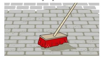
Den Fugensand bis Oberkante Pflaster auffüllen. Bei Neubau empfehlen wir die Verdichtung mit einer Rüttelplatte, sofern der Pflaster-/Plattenbelag für Rüttelplatten geeignet ist. Gegebenenfalls Schutzmatte verwenden. Im Anschluss die Fugen erneut auffüllen.
