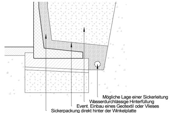
**Bild 28: Mögliche Lage einer Sickerleitung**
