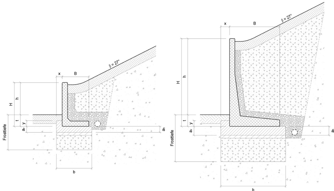
**Bild 49: Fundamentabmessungen für Lastfall E, Böschung 1:2;  $\beta = 27^\circ$**
