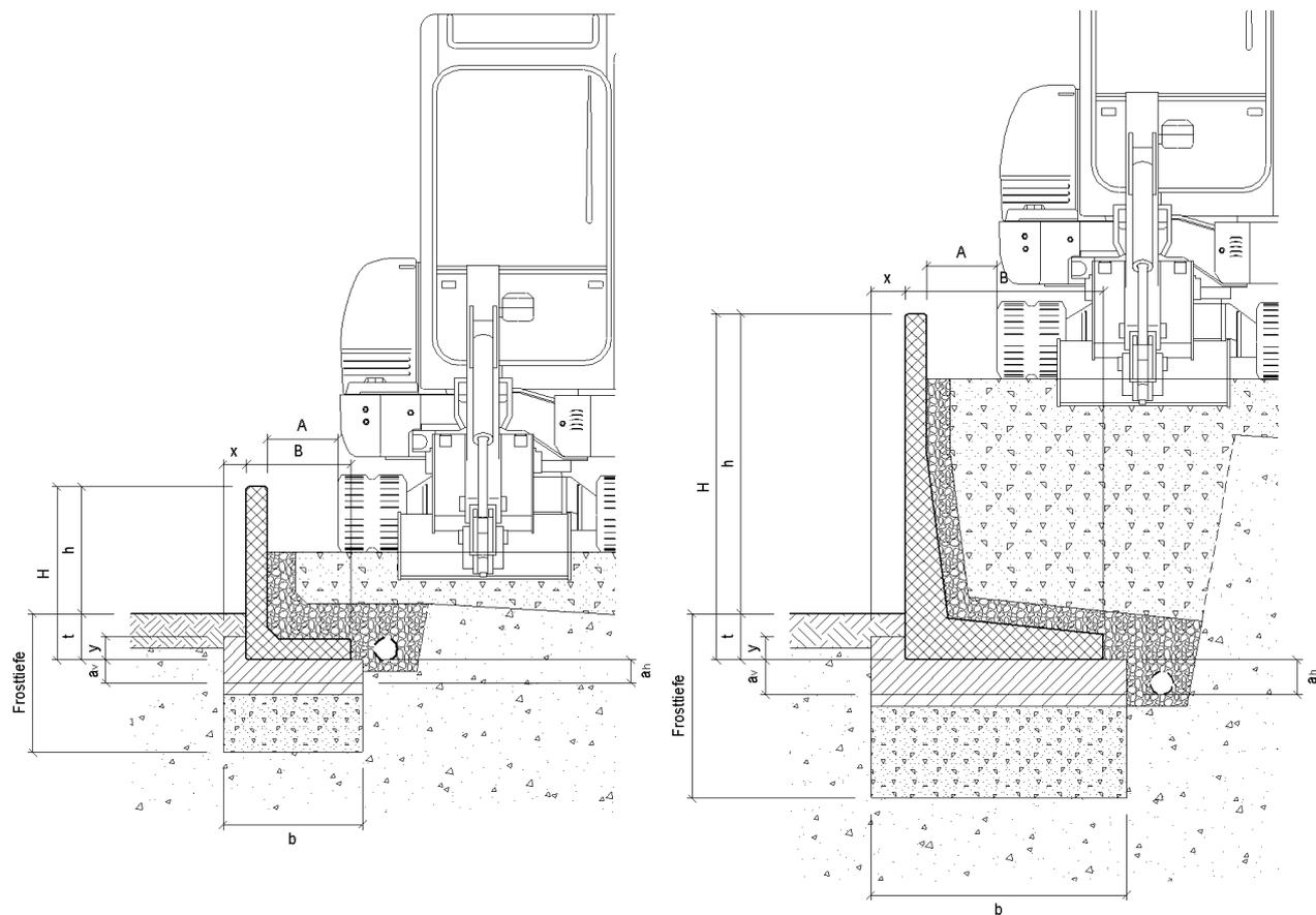
**Bild 51: Fundamentabmessungen für Lastfall G, A = 80 cm**
