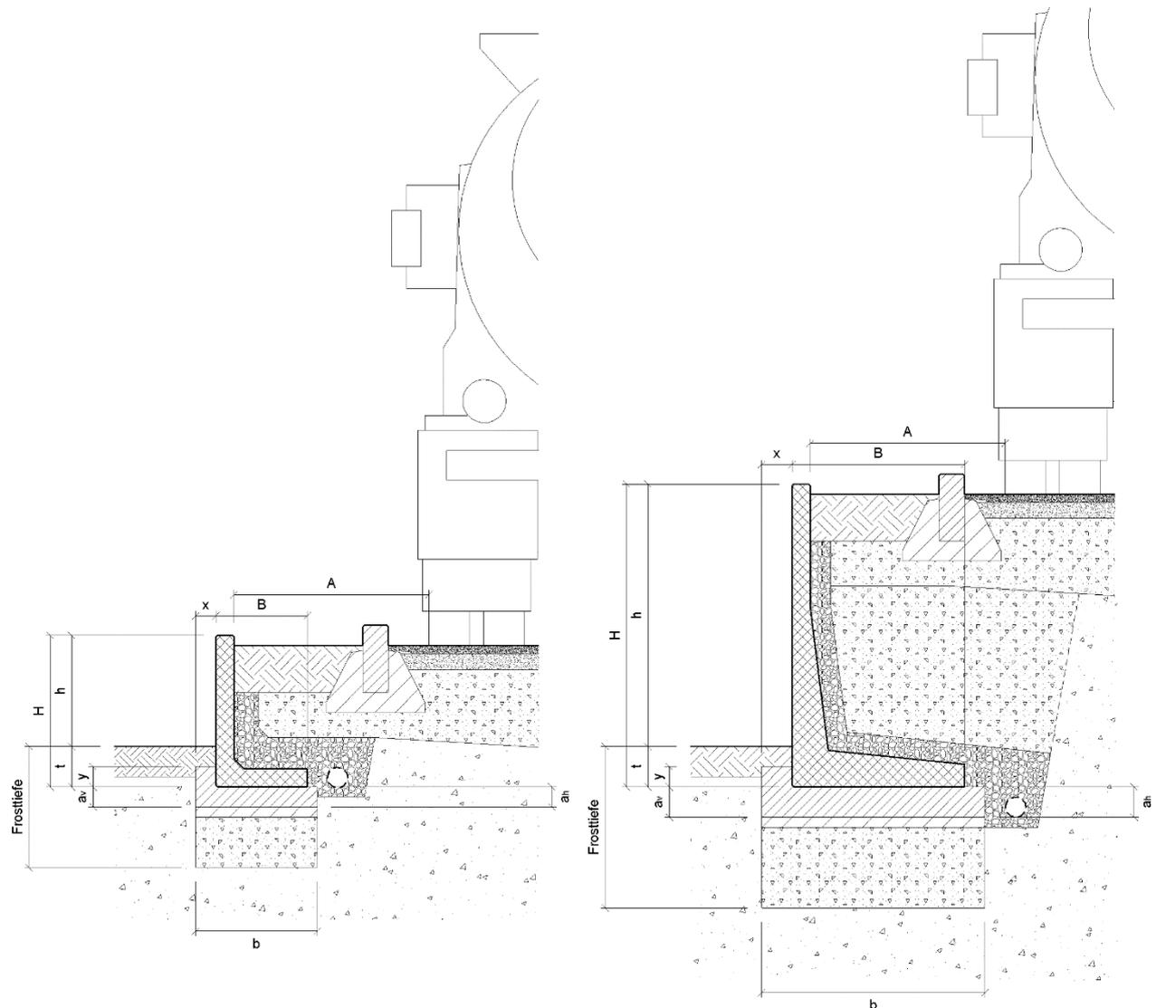
**Bild 47: Fundamentabmessungen für Lastfall C4, A = 80 cm**
