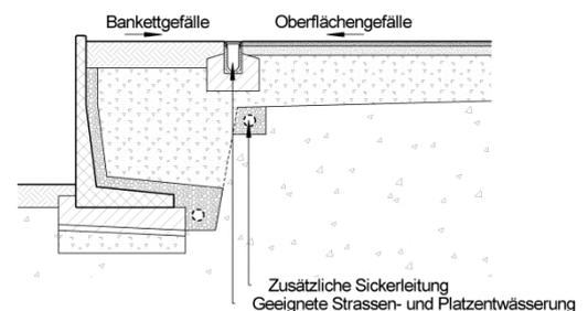
**Bild 29: Zusätzliche Entwässerung**
