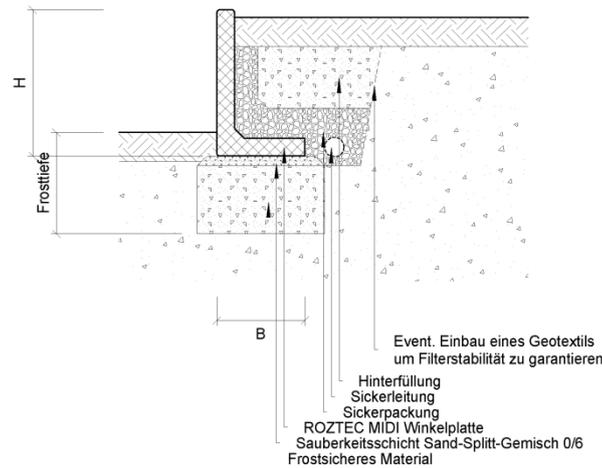
**Bild 19: Schematische Darstellung des Aufbaus ohne Streifenfundament**
