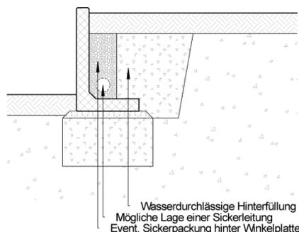
**Bild 27: Mögliche Lage einer Sickerleitung**
