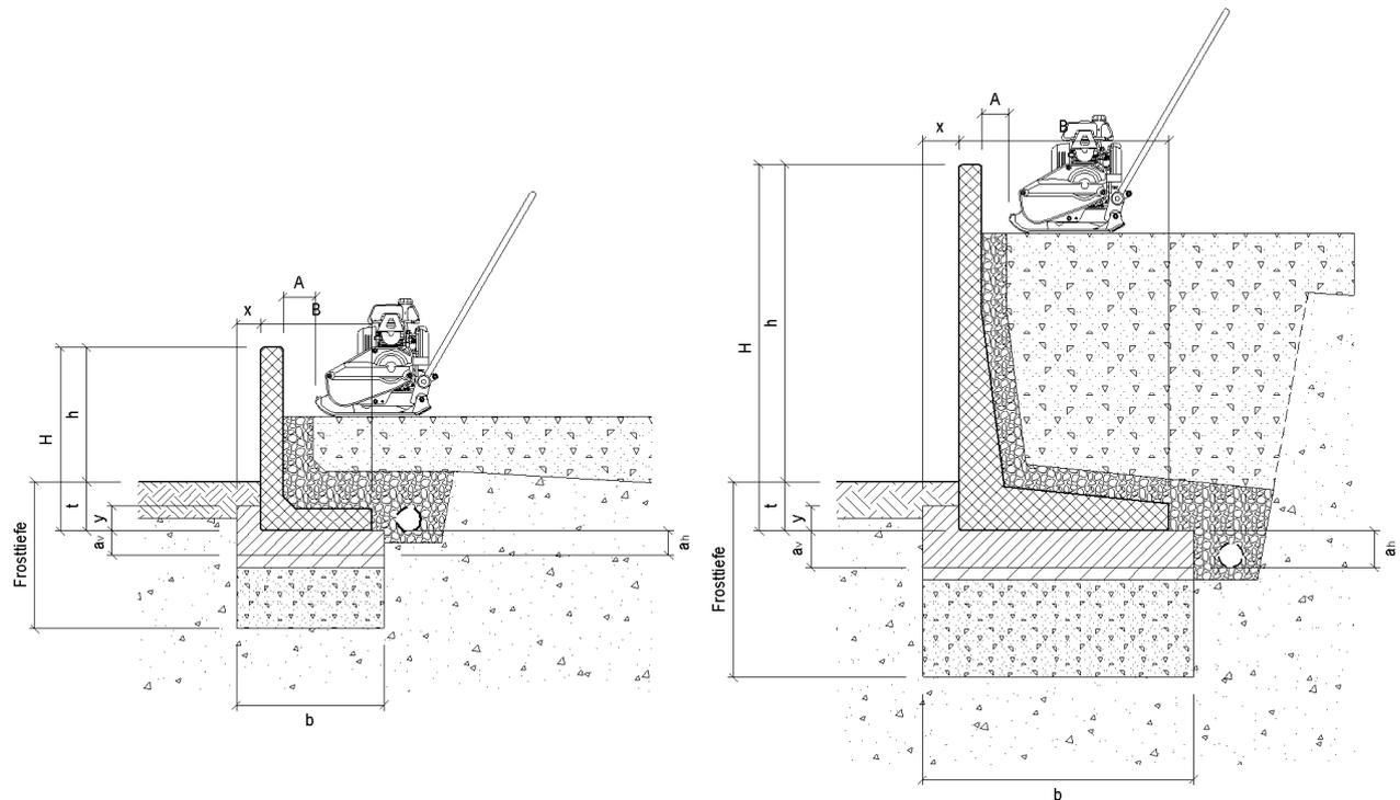
**Bild 50: Fundamentabmessungen für Lastfall F, A = 20 cm**
