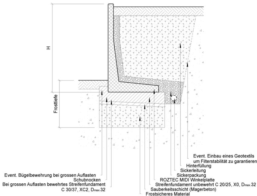
**Bild 20: Schematische Darstellung des Aufbaus mit Streifenfundament**
