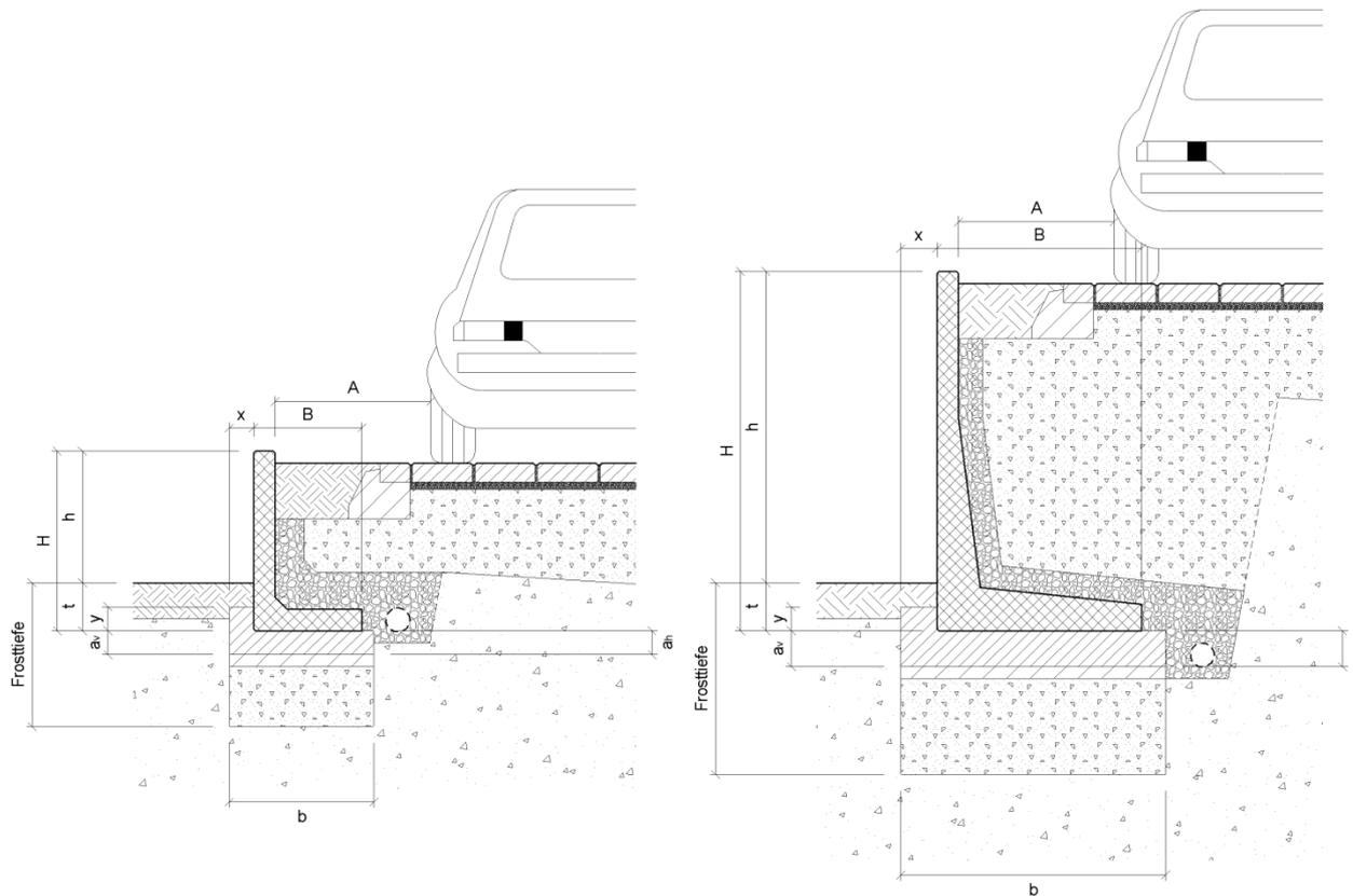
**Bild 46: Fundamentabmessungen für Lastfall B2, A = 50 cm**
