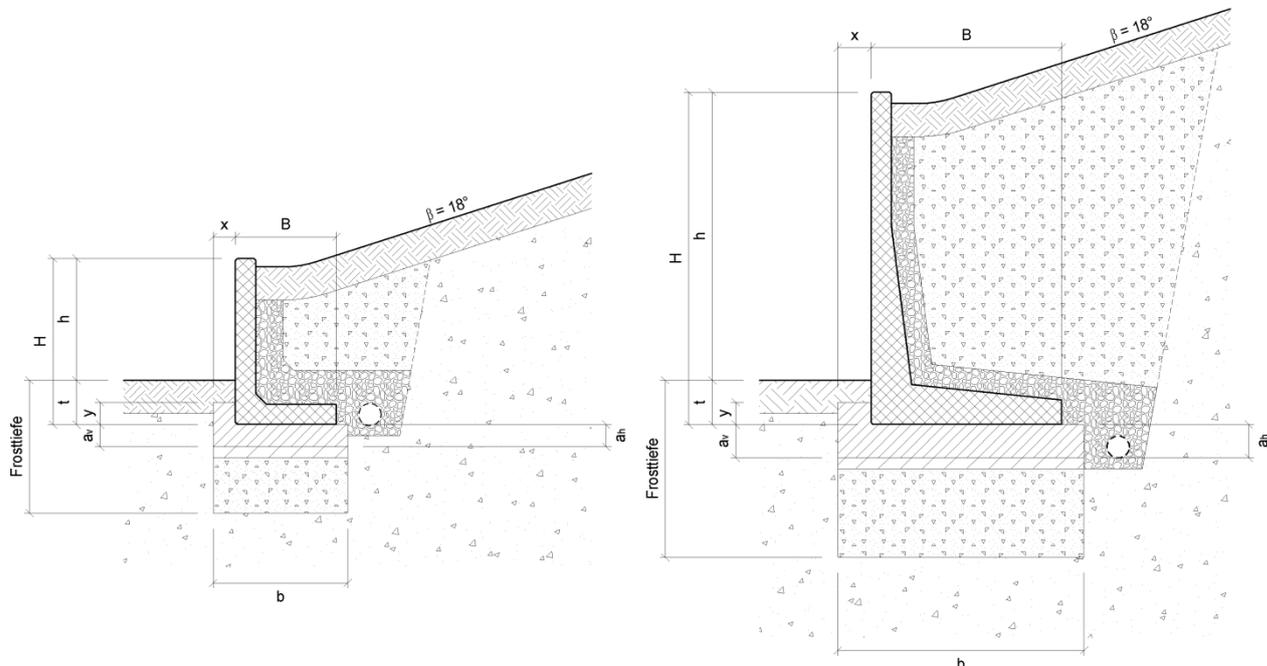
**Bild 48: Fundamentabmessungen für Lastfall D, Böschung 1:3,  $\beta = 18^\circ$**
