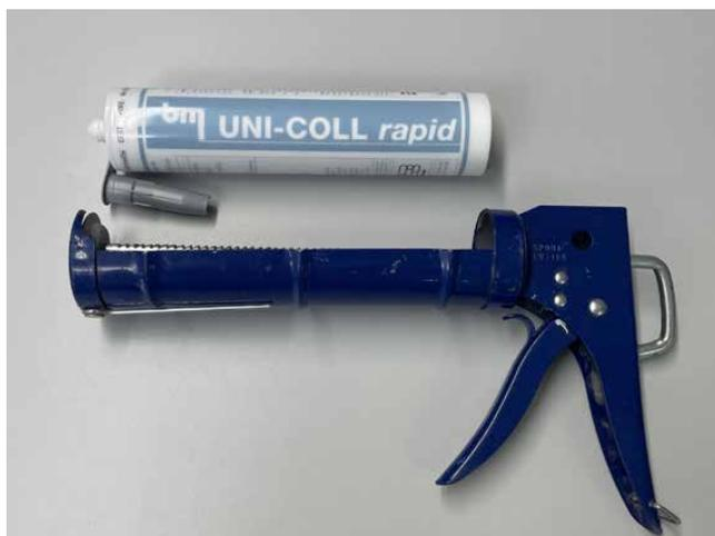
Bild 4: Auspresspistole für Kartuschen 290 ml
