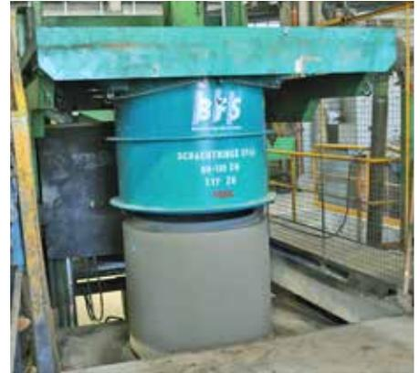
Schachtaufbauteile werden in Serienfertigung hergestellt. Neben der ständigen Überwachung des Frischbetons beginnen die Qualitätskontrollen der einzelnen Bauteile bereits kurz nach der Produktion.
