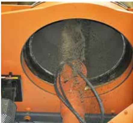
Für die Schachtunterteilerfertigung werden entsprechende Rohlinge in entsprechender Höhe und Wandstärke erstellt. Nach kurzer Erhärtungszeit sind die Bauteile für die Weiterverarbeitung bereit.
