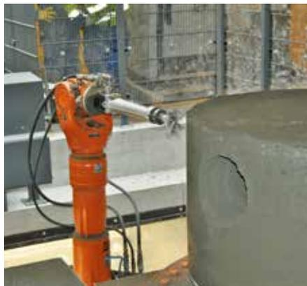
Das Modellieren des Gerinnes und die Bildung der Anschlussmuffen erfolgt mit einer CNC-Fräsung im noch frischen Beton. Nach Erreichen der notwendigen Festigkeit des Betons wird das Gerinne und der Auftritt mit einem standsischeren, abriebfesten Mörtel überzogen.
