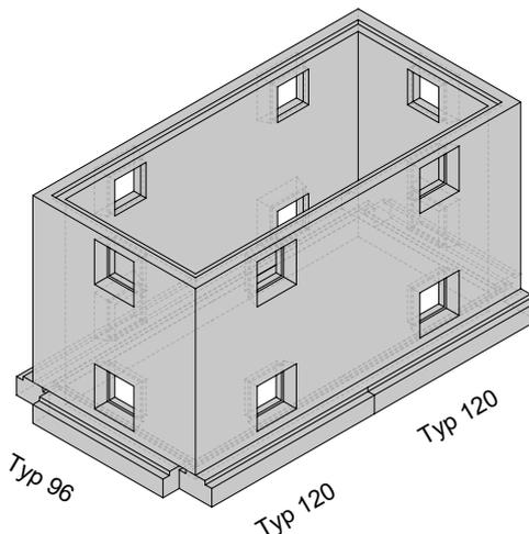
Für die Hohlraumelemente mit der Abmessung 120x240 cm werden zwei Fusselemente Typ 96 und vier Typ 120 benötigt.
