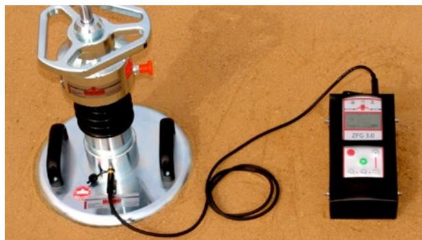
Kontrolle der Verdichtungsarbeiten mit dynamischen Lastplattenversuch
