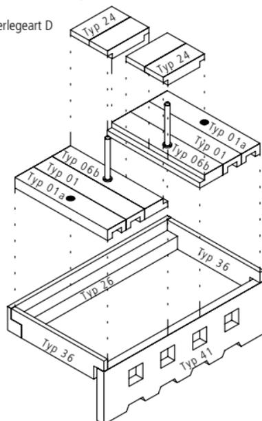
Element-Typen mit a: für Belüftungs- und Bewässerungsstutzen
