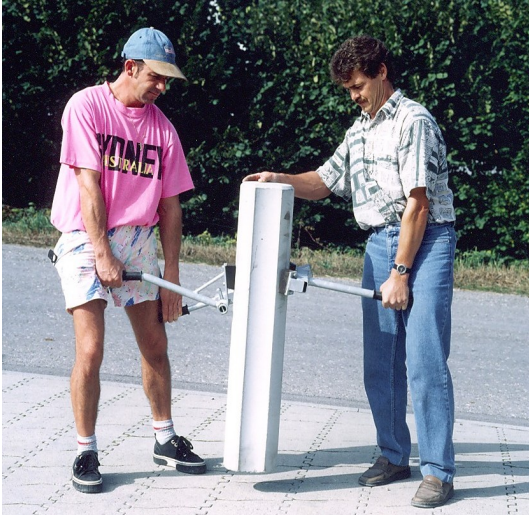
Bild 6: Transport mit Versetzzange
