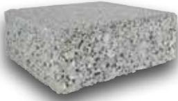
CARENA® Sickersteine fino sind haufwerksporig hergestellte Pflastersteine. Haufwerke sind Gemische fester Partikel in loser Vermengung. Deshalb sind unsere Sickersteine wasser- und luftdurchlässig sowie frostsicher, nicht aber tausalzbeständig. Mit «fino» bezeichnen wir den deckenden Betonvorsatz mit der feinen Oberfläche über dem Kernbeton.
