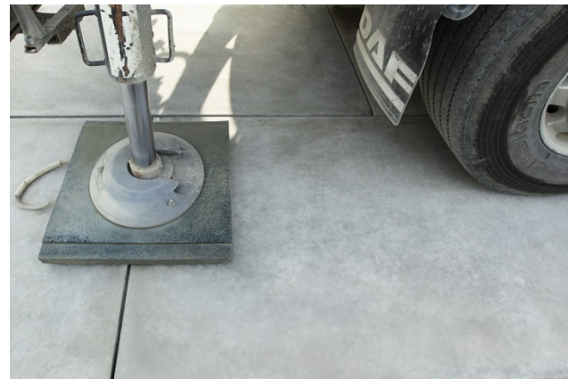
Bild 11: Mit Lastverteilplatte und Lastverteilung über zwei Platten
