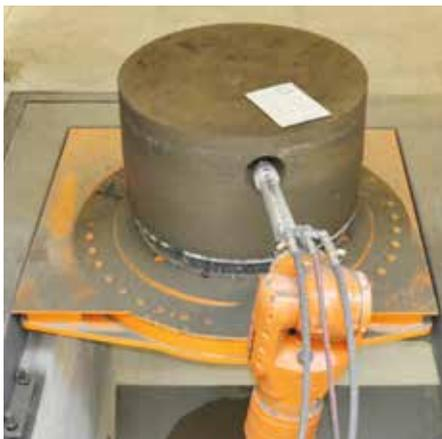
Nach dem Fräsen der Gerinne von unten wechselt der Roboter automatisch das Werkzeug und beginnt von aussen mit dem Fräsen der Anschlussmuffen, passgenau zum Gerinne. Für das Fräsen der weiteren Anschlüsse dreht sich der Rohling um die eigene Achse.
