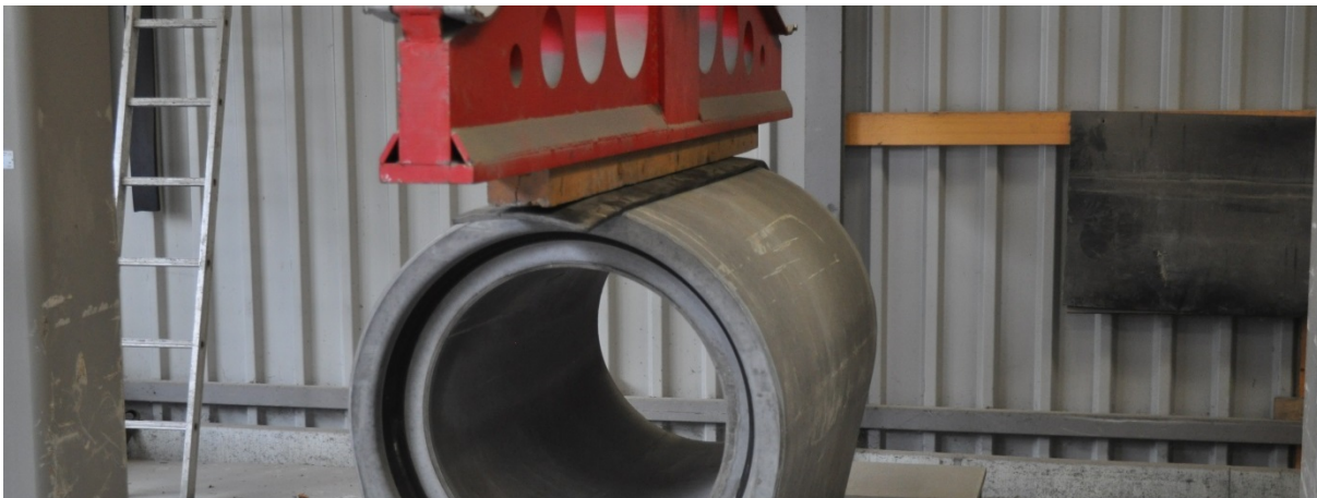
Bild 1: MAROWA® Hochleistungsbetonrohre werden statistisch nach Norm SN EN 1917 (SIA 190.171) überwacht und überprüft
