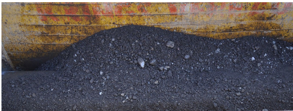
Bild 5: Recyclingmaterial kann verwendet werden, solange es verdichtbar ist
