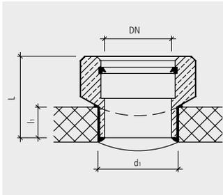
Um den extrem hohen Anforderungen von Anschlüssen an Rohrleitungen aus Beton, Stahlbeton oder Polymerbeton gerecht zu werden, muss eine dauerhafte und sichere Einleitung der gewerblichen und kommunalen Abwässer gewährleistet sein. Diese hohen Anforderungen kann nur ein Anschlussstück erfüllen, welches neben seinen grundfunktionalen Eigenschaften auch die, vor allem leichte und unkomplizierte Verarbeitung auf der Baustelle zur Voraussetzung hat.
