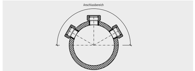
Werden mehrere Anschlussleitungen an ein einzelnes Hauptrohr angeschlossen, so muss eine minimale Distanz zwischen den Bohrlochwandungen von 1000 mm eingehalten werden. Die Distanz zwischen Rohrende bzw. Glockenmuffenansatz des Hauptrohres und der Bohrlochwandung sollte mindestens die doppelte Nennweite der Anschlussleitung aufweisen.
