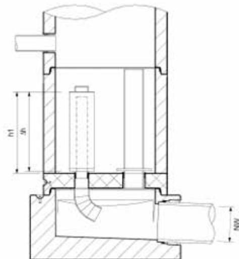
Bei einem Durchlaufschacht sollte der an der Zwischenplatte montierte Bogen nicht in die bemessene maximale Teilfüllung ragen. Entsprechend ist die Höhe des Unterteils zu wählen. Es kann aus gewichtstechnischen Gründen auch ein Unterteil mit geringerer Höhe und ein Zwischenring gewählt werden.
