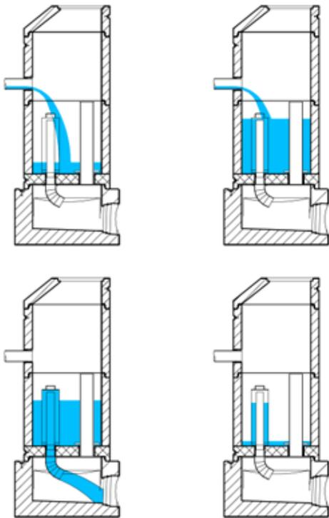
Bild 3: Funktion des CENTUB® Spülschachtes
