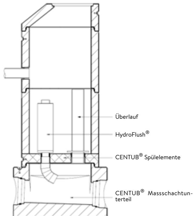
Bild 1: Schnitt des CENTUB® Spülelementes auf einem CENTUB® Massschachtunterteil
