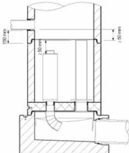
Bild 6: Anordnung des Zulaufes und des Überlaufes
