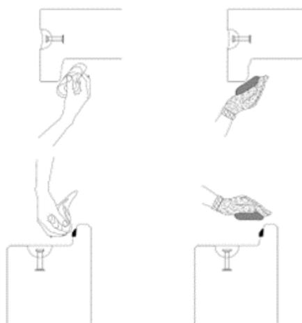
Schachtfertigteile mit werkseitig gelieferten Dichtungen können in der Regel bis zu Bauteiltemperaturen von - 5°C verlegt werden. Bei Bauteiltemperaturen zwischen - 5°C und -10°C müssen zusätzliche Massnahmen getroffen werden. So können die Dichtringe und Gleitmittel in einem geheizten Raum gelagert werden.
