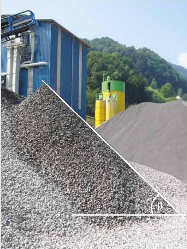
Natürlicher Böschungswinkel \beta
