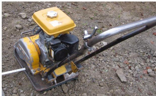
Bild 29: Verdichten nur mit sehr leichten Verdichtungsgeräten
