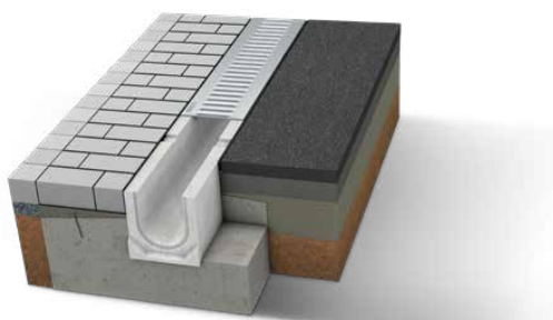
Illustration 1 : caniveau de drainage BIRCOplus en béton
