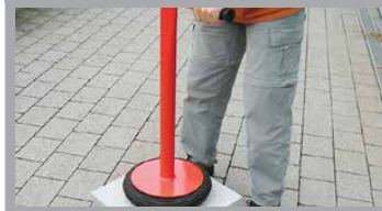
PORTE-DALLES PNEUMATIQUE PAR VIDE D'AIR
