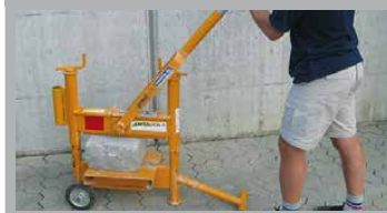
STEINSPALTER FÜR SANTURO® MAUERSTEINE
